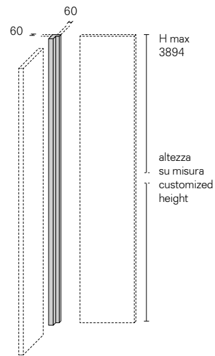
Montante angolare per pannelli ad angolo interno Corner upright for internal corner panels
